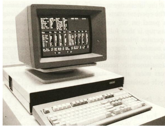
איור 6. מסוף PCT בפאב-8 ירושלים — ממשק מפעיל לבחירת מתכון ואישור ריצה. [תצלום פנימי, ארכיון אינטל פאב-8]
